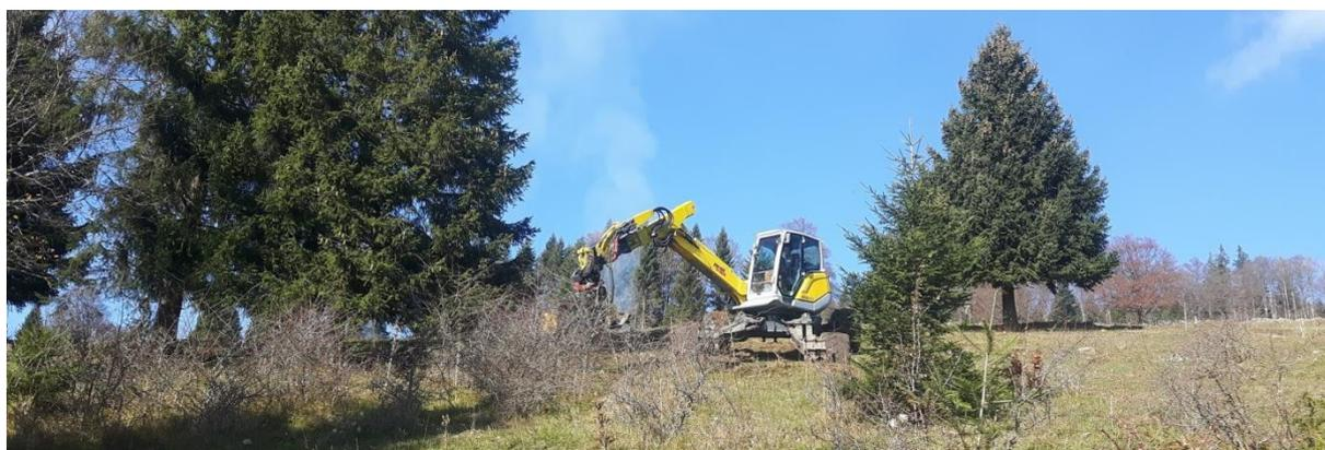
Broyeur mécanique sur Menzi Muck
